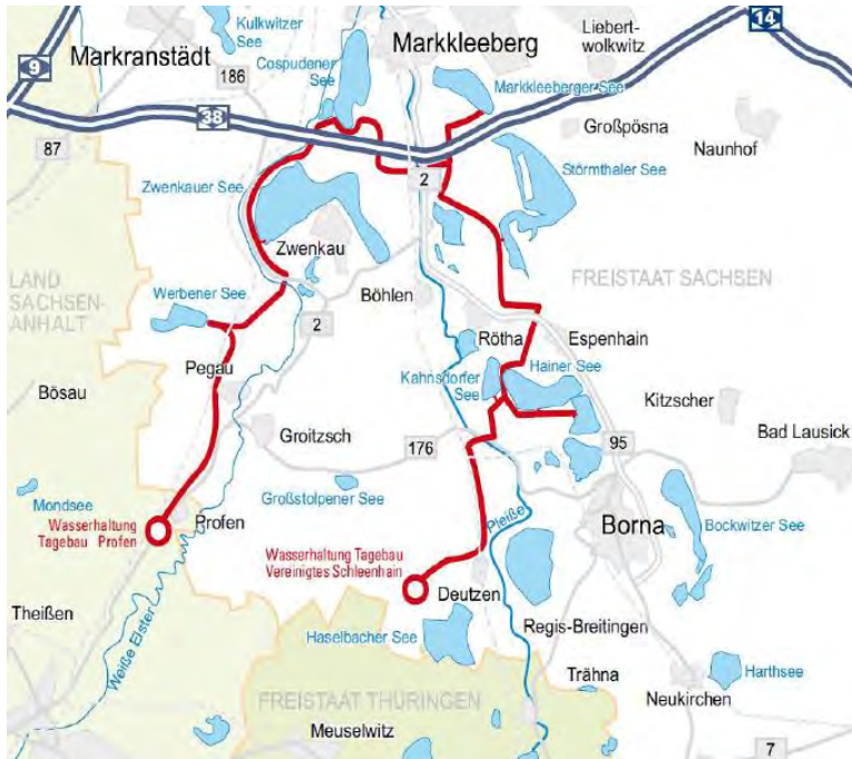
Abbildung 55: Nutzung von Sumpfungswasser zur Flutung von Bergbaufolgeseen im Südraum Leipzig 128
