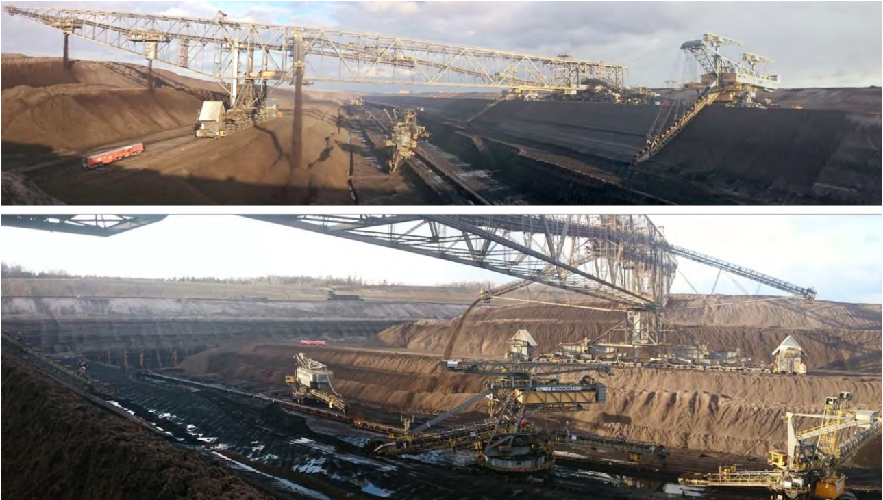
Abbildung 15: Panoramen Tagebau Welzow-Süd mit aktivem Abbaubereich Oben rechts Anschnitt miozäner Ablagerungen mit horizontaler Lagerung und schwarzen Kohleflözen. Darunter Kohleabbaustrassen mit Kohlentransportbandanlage. Abraumverkipfung durch Abraumförderbrücke. 25
