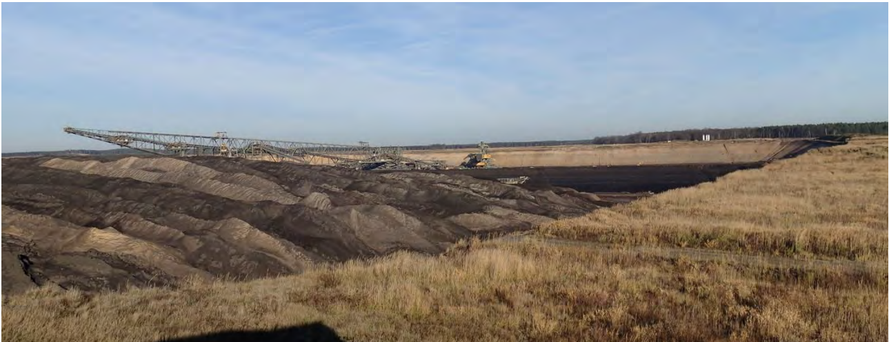
Abbildung 35: Panorama Tagebau Reichwalde Dezember 2015 Östlicher Tagebaurand im Südfeld mit Abraumförderbrücke und deren Kippenfeld. Abbaustoß mit Zweitem Lausitzer Flöz und Deck- schichten, ohne Vorschnitt 90
