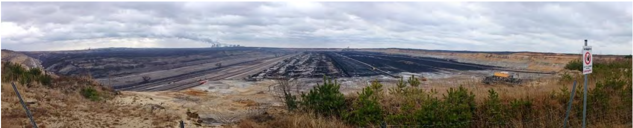
Abbildung 26: Panorama Tagebau Nochten, Nordostende der Abbaustrosse Rechts freigelegtes Oberflöz mit Kohleförderband. Links Grubenbetrieb mit Baggern an nach links anschließendem Kippenfeld 66
