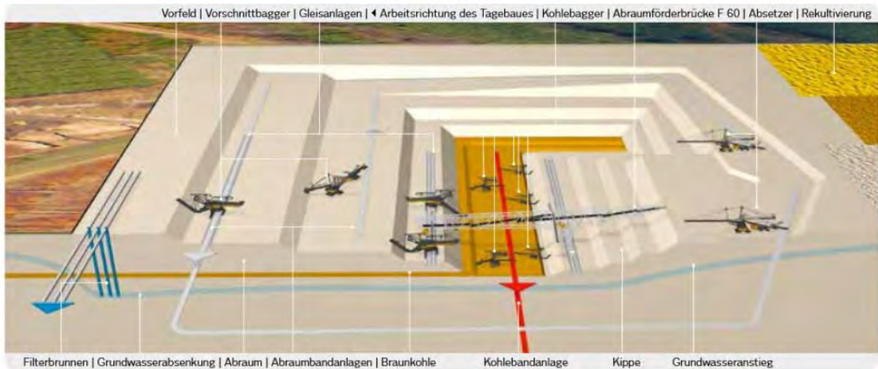
Abbildung 43: Arbeitsprinzip Tagebau Welzow-Süd TA I, Südfeld 111
